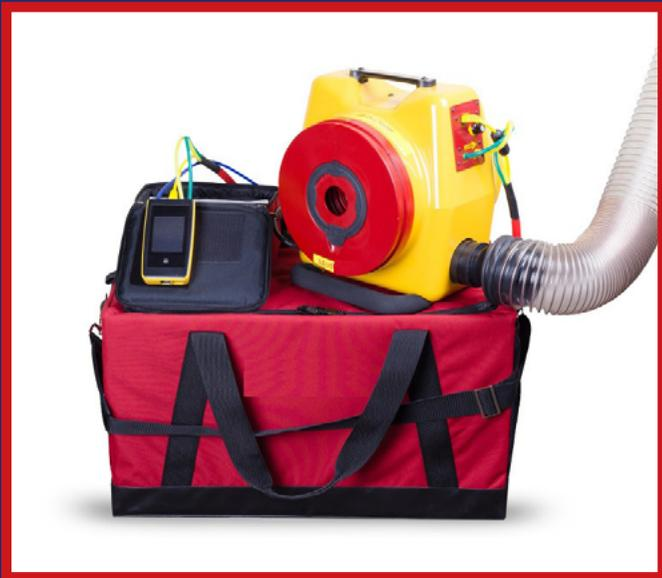
Este dispositivo se destina a execução de testes de estanqueidade (vazamento) em dutos de ar condicionado ou gabinetes de unidades de tratamento de ar (fan-coil, AHU e etc.)
