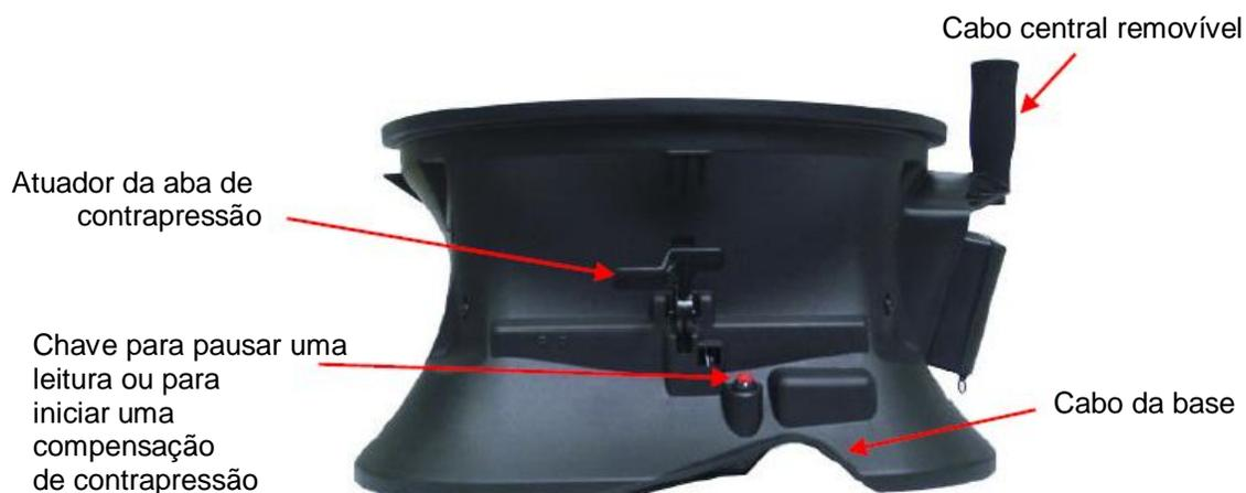
Figura 3: Recursos da base do EBT Balometer®, vista lateral
