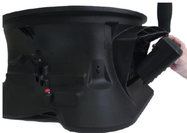
Figura 10: Acoplamento do instrumento na base do captor
