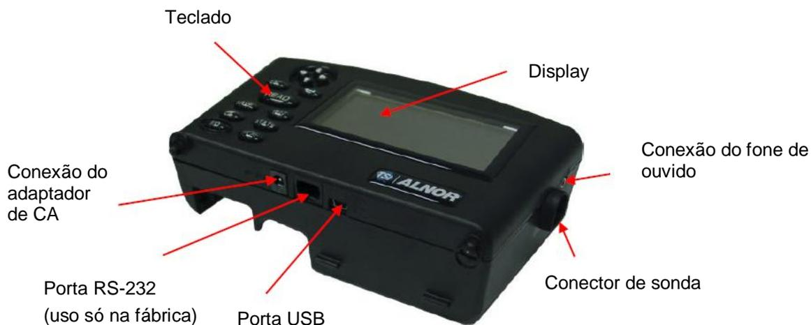
Figura 1: Recursos do micromanômetro EBT730/EBT731, vista frontal
