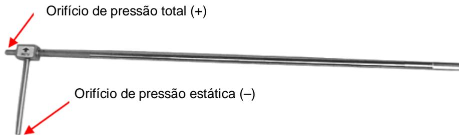
Figura 12: Sonda de fluxo de ar
