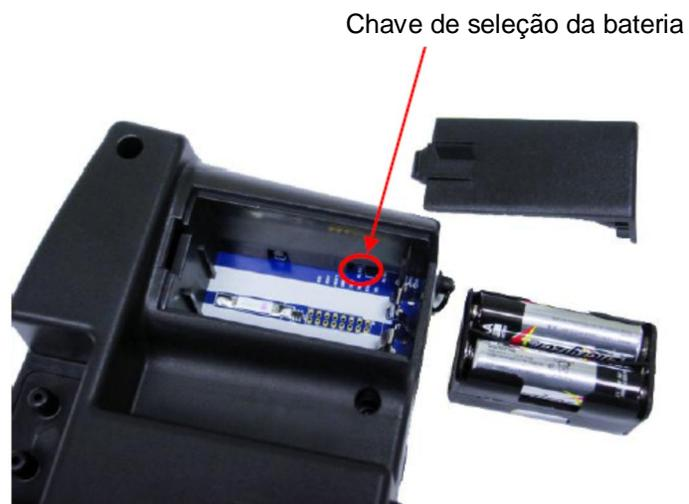
**Figura 6. Posição da chave seletora do tipo de bateria**
