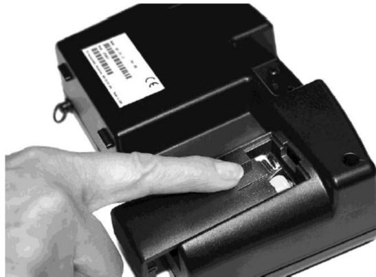
**Figura 5. Remoção da tampa das baterias**
