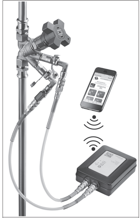
Fig. 6: Exemple de raccordement
