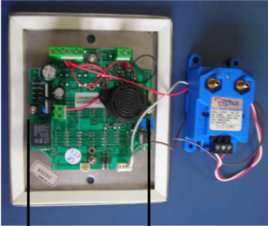
Largura e comprimento da placa eletrônica = 110 X 110 mm
